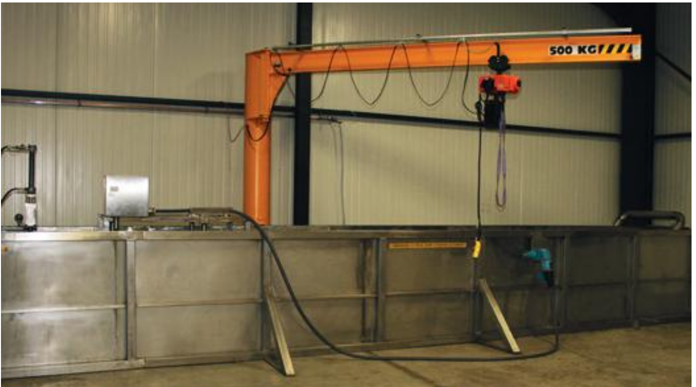
Nieuwe test bank van 7 m voor testen van pompen tot 400 m 3 /u / Nouveau banc test de 7 m pour le test des pompes jusqu'à 400 m 3 /h
